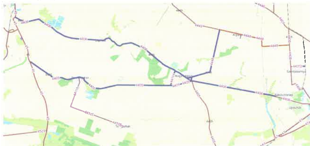
103. ábra: A fejlesztésre javasolt 4405 és 4406 jelű utak, kékkel jelölve a 7,5 t-ig történő súlykorlátozás
